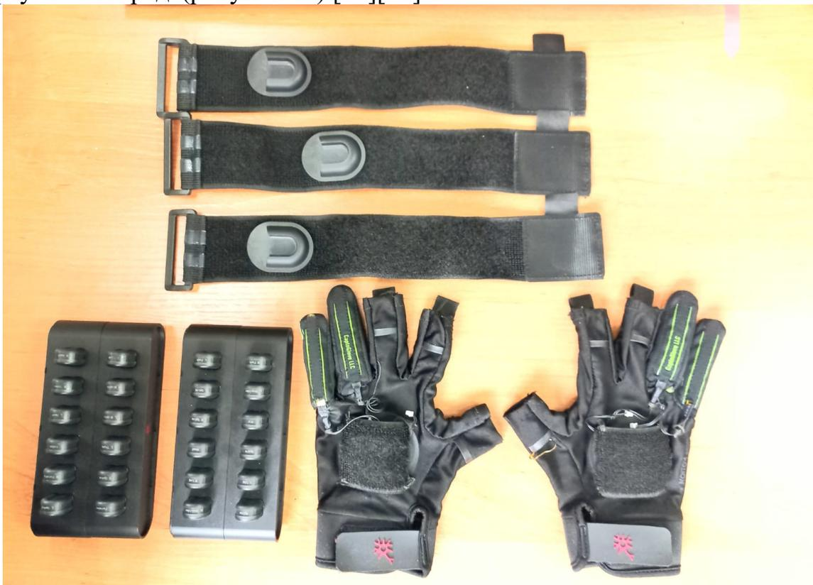
Рисунок 13. Датчики для захвата движения рук и верхней части тела
